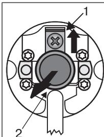
La espiga (2) se enclava automáticamente al introducirla. Para soltarla, desplace hacia arriba la chapa de seguridad (1) y extraiga la espiga (2).
