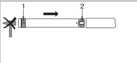
Monte el automatismo tubular con el anillo correspondiente (1) y la rueda motriz (2). En caso de que el anillo cuente con varias ranuras, escoja la ranura exacta y deslice el anillo (1) sobre el anillo de rodadura.
