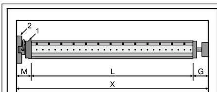
Determine la demanda de espacio lateral (M) midiendo el cabezal del automatismo (1) y el soporte mural (2). La longitud (L) del eje enrollador se obtiene a partir de la anchura interior de la caja (X) menos la demanda de espacio lateral (M) y el contrasoposte (G):  $L=X-M-G$ .
