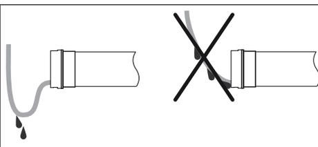
**Tendido del cable de conexión**
