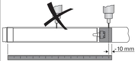
Para asegurar una transmisión segura del momento de torsión en ejes cilíndricos, recomendamos atornillar la rueda motriz con el eje (ver la tabla siguiente).
