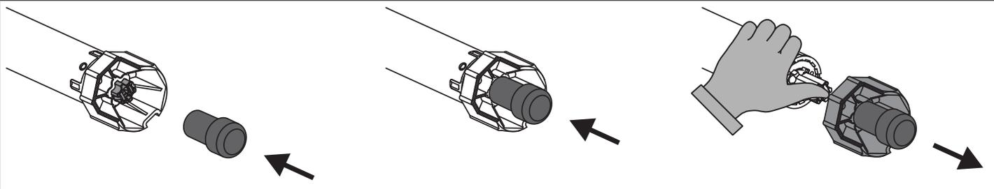
Desmontaje con unas pinzas de punta
